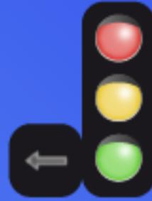
Выключенный сигнал дополнительной секции или включенный световой сигнал красного цвета ее контура означает запрещение движения в направлении
